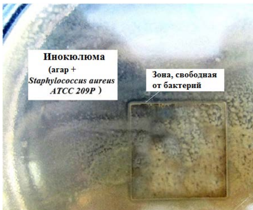
Рисунок 49 - Фотография, иллюстрирующая высокую прозрачность и бактерицидные свойства смешанного \text{ZnO-CeO}_2 покрытия, нанесенного на поверхность стекла полимерно-солевым методом
