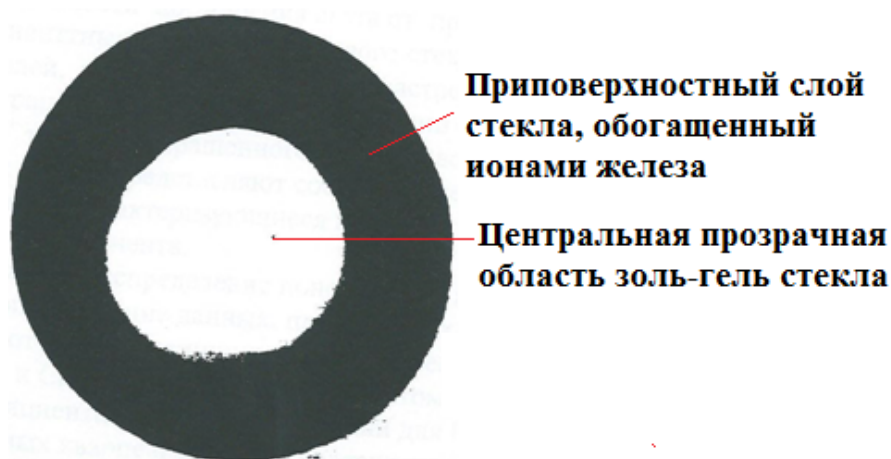
Рисунок 21- Фотография образца градиентного по светопоглощению золь-гель стекла, модифицированного ионами железа
