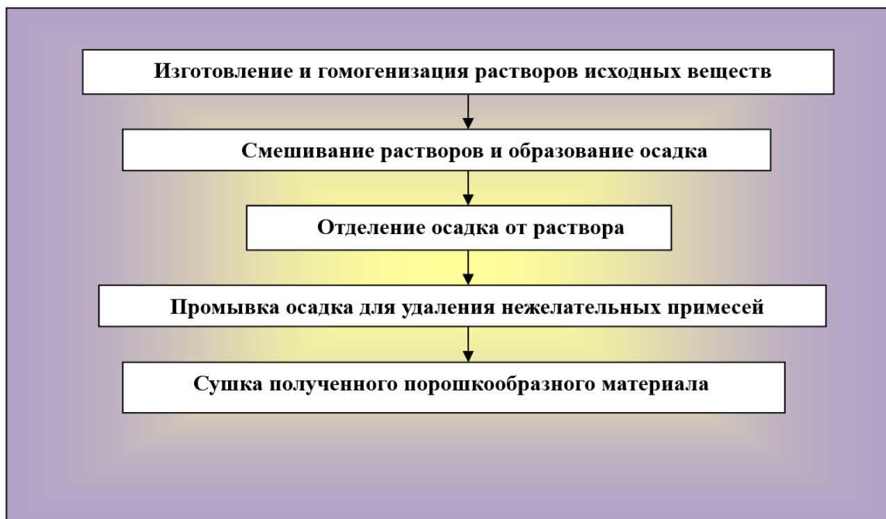
Рисунок 54 - Общая схема получения наноматериалов методом осаждения из растворов
