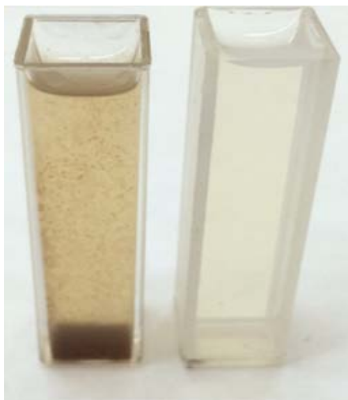
Рисунок 36 - Фотографии зольей PbS, стабилизированных низкомолекулярным ПВП ( M_s = 10000 ) (левая кювета) и высокомолекулярным ПВП ( M_s = 1300000 )
