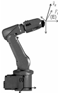
Рис. 1.5. Системы координат манипулятора в операционном пространстве: \{I\} – инерциальная (базовая) система координат, \{E\} – система координат, "прикрепленная" к рабочему инструменту манипулятора
