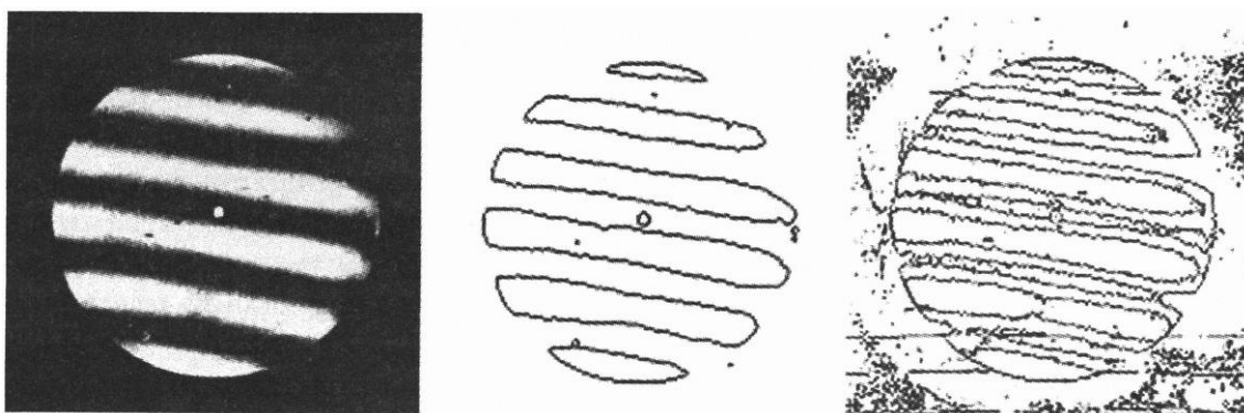
Рис. 25. Обработка интерференционного изображения с целью повышения точности измерения координат полос
