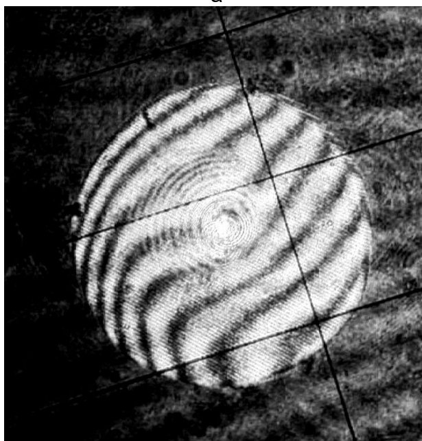
Рис. 14. Объектив Индустар-50 на интерферометре Физо (а); интерферограмма объектива Индустар-50 (б)
