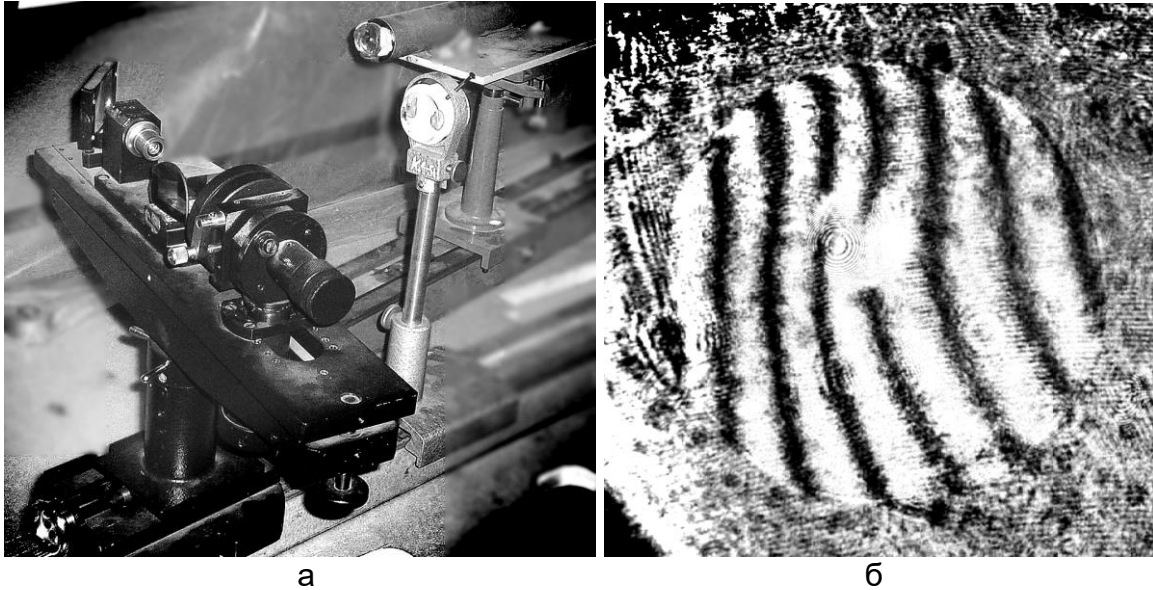
Рис. 17. Лазерный неравноплечий интерферометр – общий вид (а); интерферограмма оптической поверхности (очковая линза) (б)
