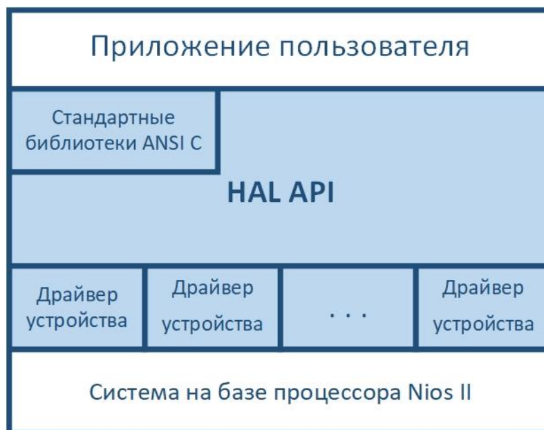
Рисунок 5.4 Условное расположение HAL при разработке встраиваемых систем для Nios II
