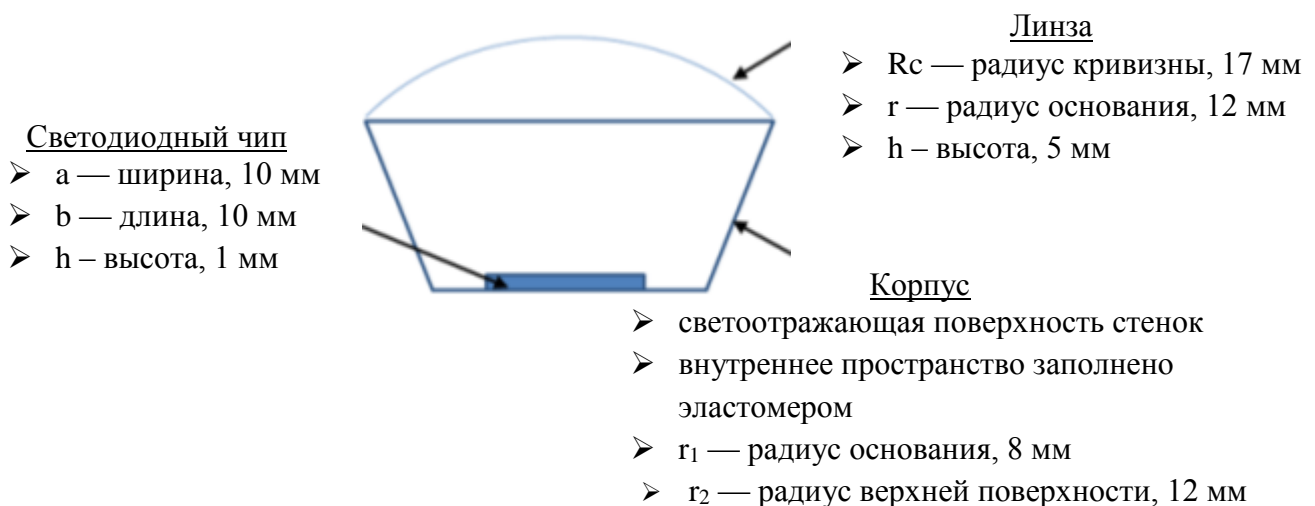
Рис. 26. Схема двух рассчитываемых светодиодов.
