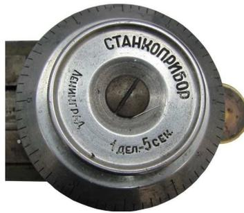
Рисунок 4.13 – Шкала поворотного столика
