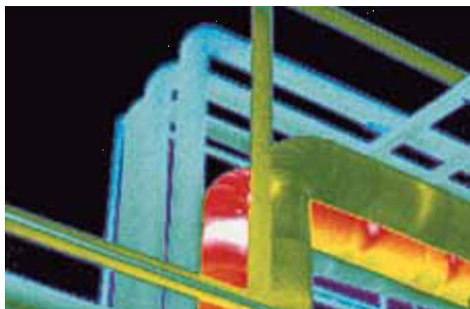
Рисунок 4.26 – Иллюстрация применения ТВП FLIR для получения теплового портрета конструкций в нефтехимической промышленности заимствована из дидактических материалов фирмы FLIR
