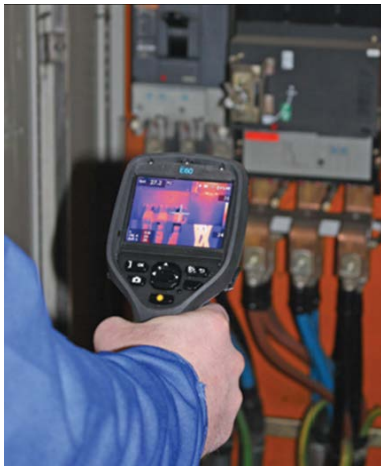
Рисунок 4.14 – Иллюстрация из материалов фирмы FLIR. Применение ТВП FLIR Exx-Series для обследования электроэнергетического оборудования. Видны зоны с повышенной температурой оборудования
