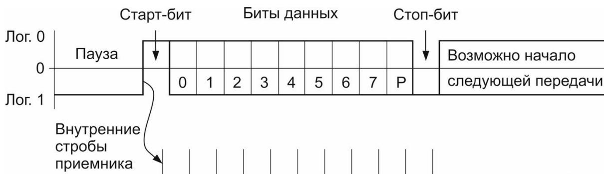
Рисунок 32 – Формат асинхронной передачи
