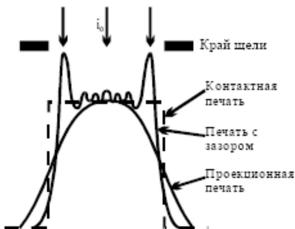
Рис. 24. Профили распределения интенсивности в изображении для случаев контактной печати, печати с зазором и проекционной литографии
