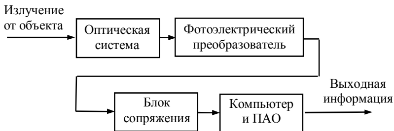
Рисунок 1.1. Блок-схема системы бесконтактного контроля объектов
