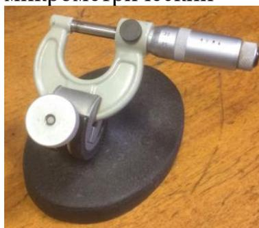
Диапазон измерения толщиномера: 0 - 25 мм, Цена деления шкалы индикатора: 0,1 мм,
