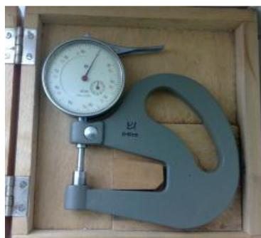
Диапазон измерения толщиномера: 0 - 25 мм,
