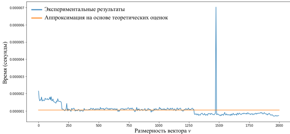
Рис. 1: Эмпирическая и теоретическая временные сложности алгоритма, реализующего функцию f(v) = 1 .
