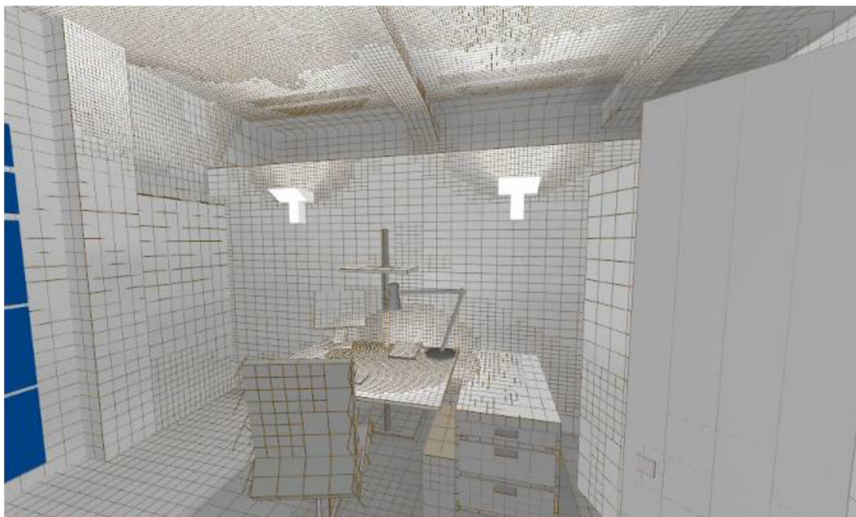
Рисунок 5.1 — 3D изображение рабочего пространства, поделенного на элементарные поверхности для последующего светотехнического расчета
