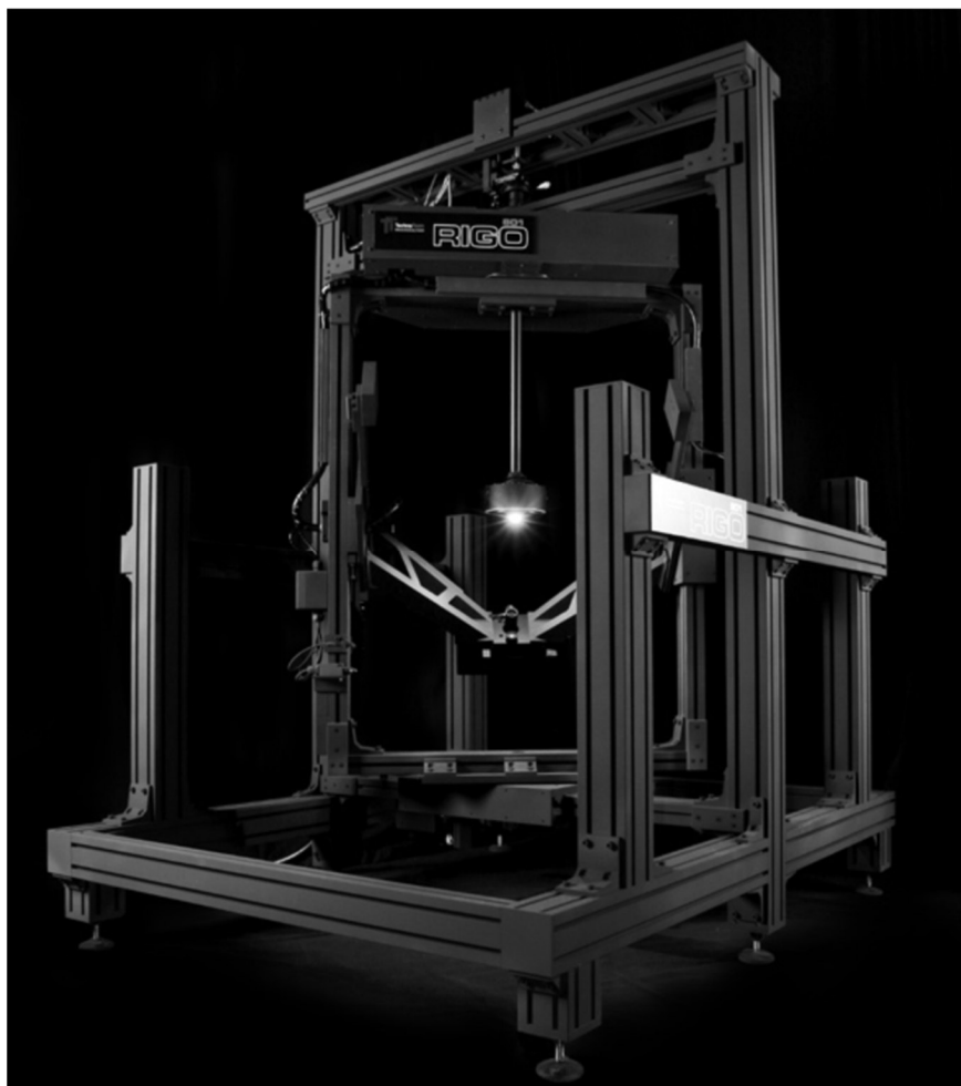
Рисунок 4.4 — Гониофотометр ближней зоны компании TechnoTeam RiGO801 – 600
