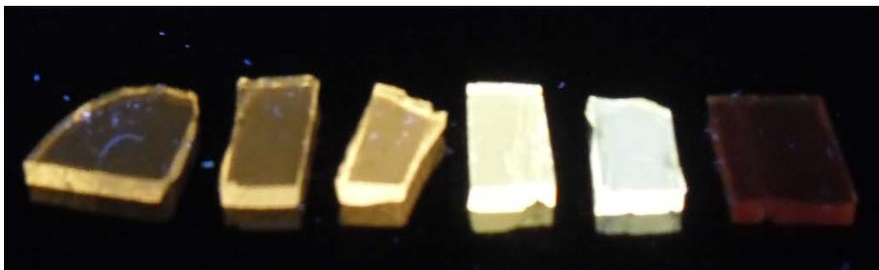
Рисунок 2.4.4 – Фото образцов натриево-алюмосиликатного стекла, содержащего 0,004 мол%  $Sb_2O_3$ , после  $Na^+-Ag^+$  ИО и термообработки в течение 15 часов при температурах 250-500 °С (увеличивается слева направо)
