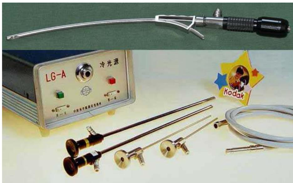
Рисунок 4.4 – Фотография медицинских эндоскопов, разработанных в [4.14] и содержащих градиентные оптические элементы, сформированные ионообменной обработкой стекол
