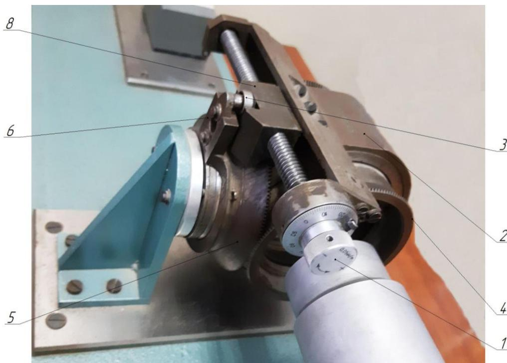
Рисунок 9 – Внешний вид двухклинового измерительного компенсатора с синусным механизмом,
