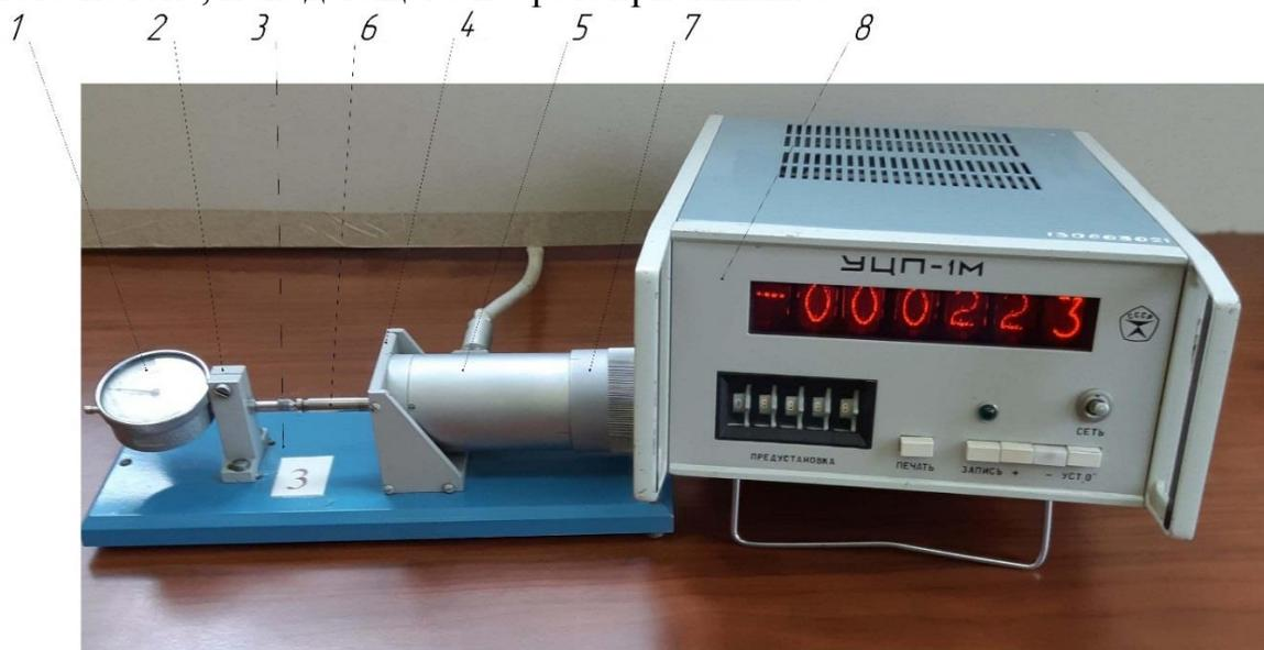
*Рисунок 2 – Схема установки для исследования индикатора, где 1 – исследуемый индикатор, 2 – кронштейн, 3 – столик, 4 – стойка датчика, 5 – фотоэлектрический датчик линейных перемещений, 6 – измерительный винт, 7 – маховичок фотоэлектрического датчика, 8 – блок индикации фотоэлектрического датчика УЦП-1М*
