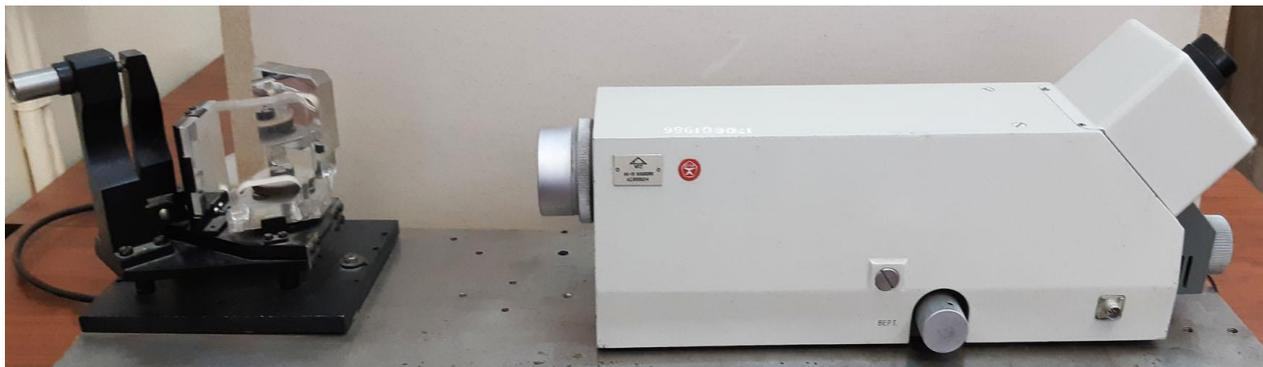
*Рисунок 3 – Установка для исследования уголкового отражателя, где 1 – станина, 2 – уголкового отражатель, 3 – автоколлиматор*
