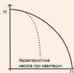
Рис. 2.2.11: Характеристика насоса при кавитации
