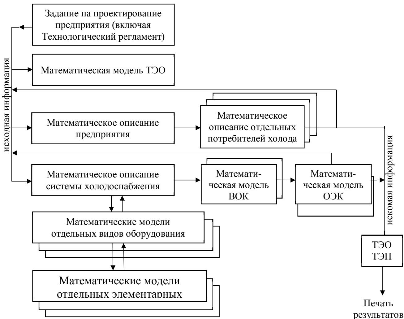
Рисунок 3.4 – Система связей математических моделей и информационных потоков в процессе оптимального компьютерного проектирования.
