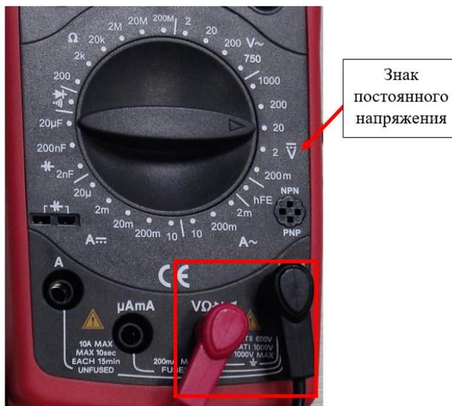
Рисунок 10 – Измерение напряжения с помощью мультиметра
