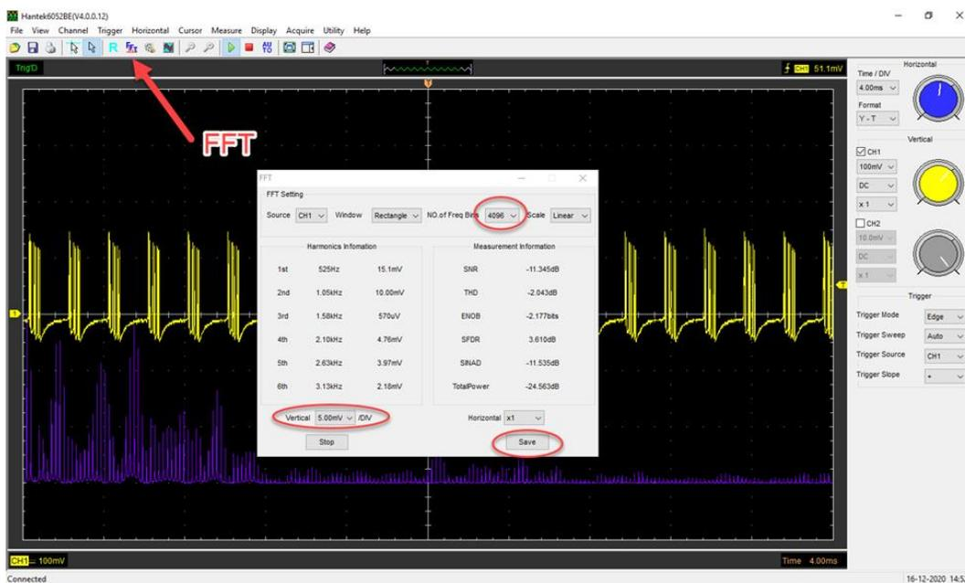
Рисунок 7 – Построение спектра сигнала
