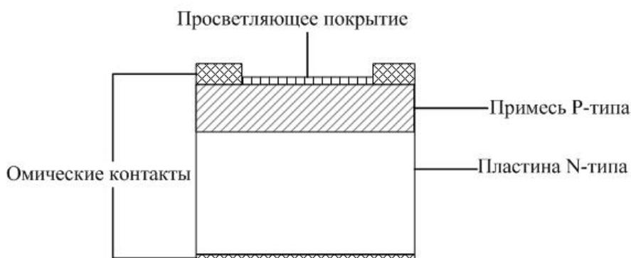
Рисунок 2.9 – Схематическое изображение PN фотодиода
