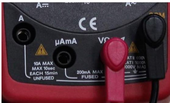
Рисунок 8 – Настройка мультиметра для измерения напряжения
