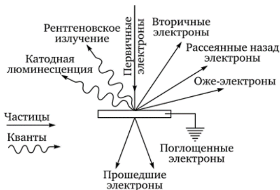
Рисунок 5.1 – Схема образования вторичных сигналов при взаимодействии электронов зонда с веществом мишени
