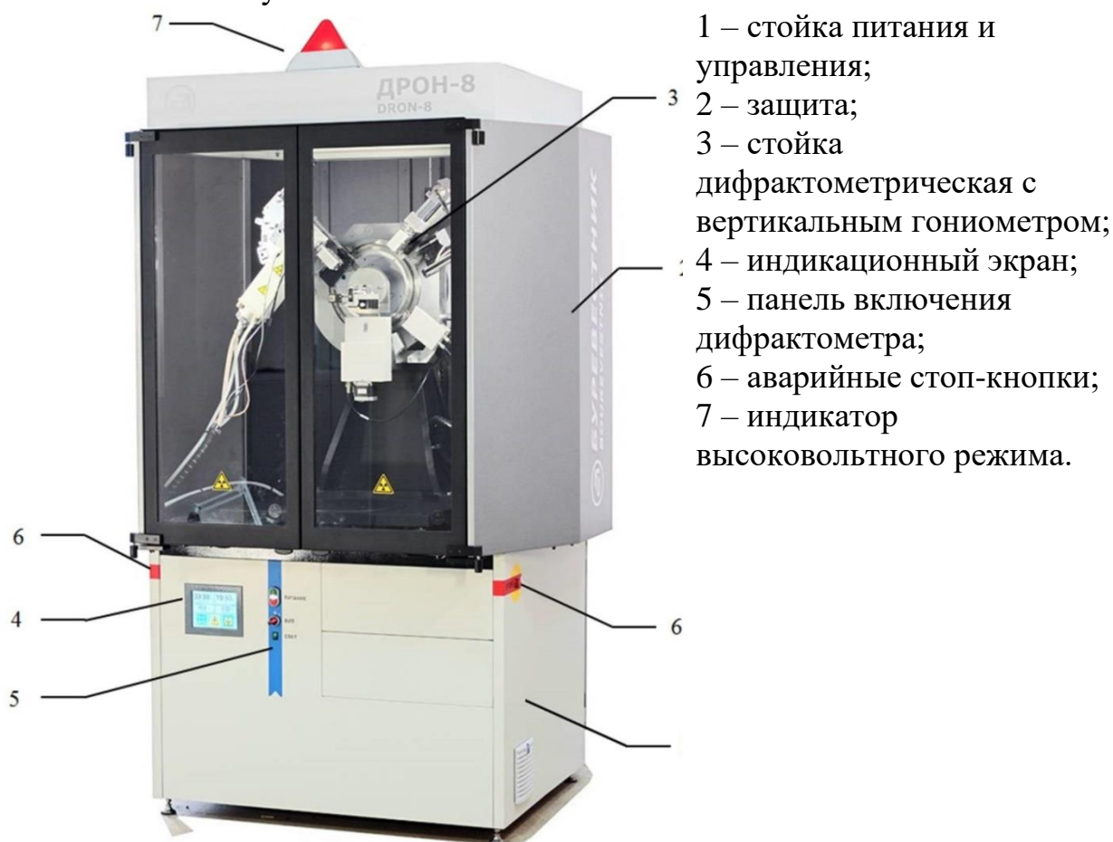
Рисунок 6.2 - Дифрактометр рентгеновский ДРОН-8
