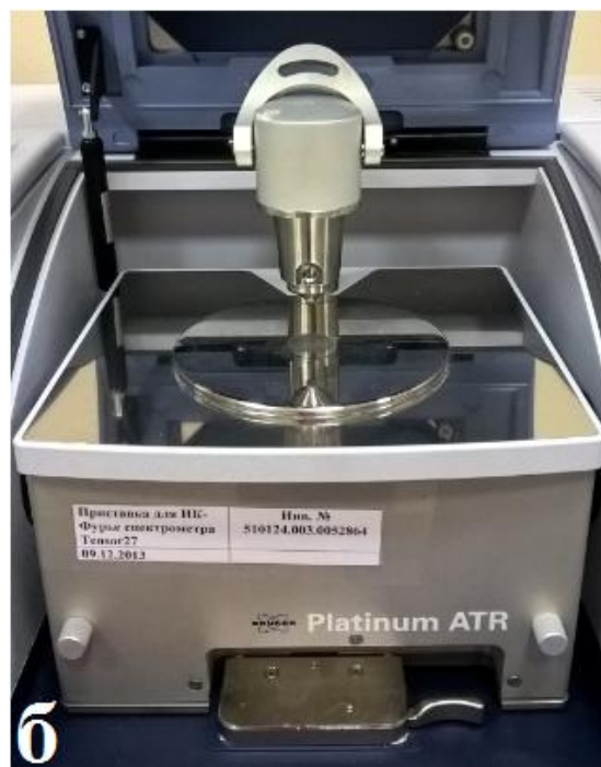
Рисунок 1.5 — (а) Кюветный отсек спектрометра "Tensor-27" с механизмом QuickLock™; (б) Приставка НПВО; (в) приставка, позволяющая измерять ИК-спектры в режиме пропускания
