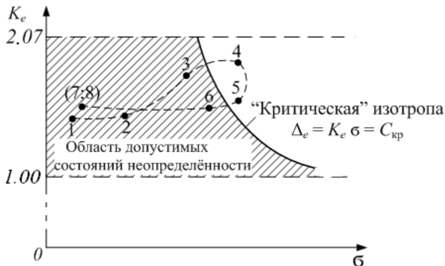
Рис. 8.6. Фрагмент энтропийного портрета состояния неопределенности температурного режима дефростационной камеры
