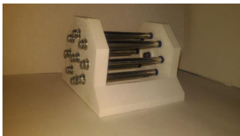
Рисунок 2.1. Электродинамическая ловушка для локализации микрочастиц.
