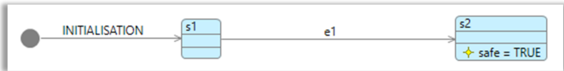
Рисунок 3.5 – Пример конечного автомата с инвариантом в состоянии s2
