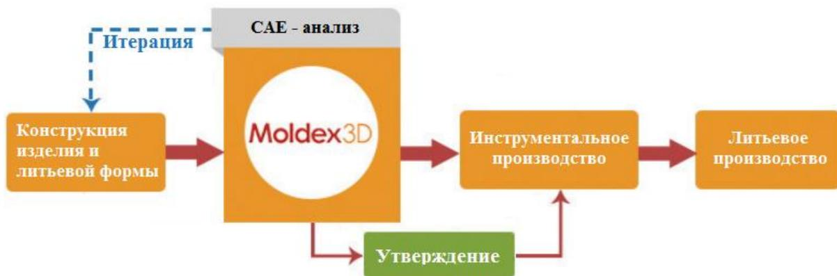
Рисунок 5 – Итерационный процесс поиска конструкторского решения
