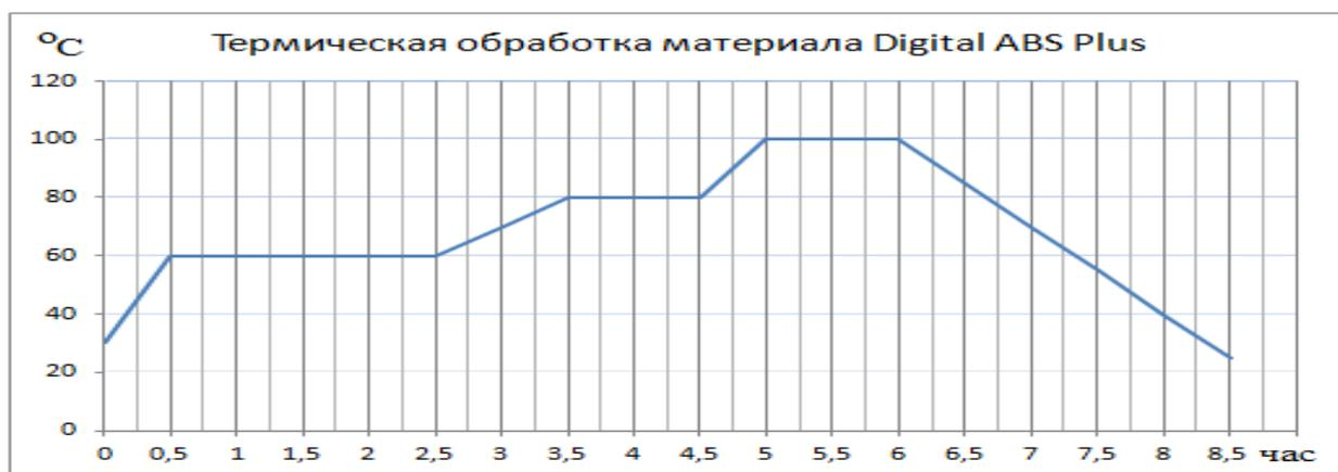
Рисунок 20 – Диаграмма повышения теплостойкости Digital ABS Plus
