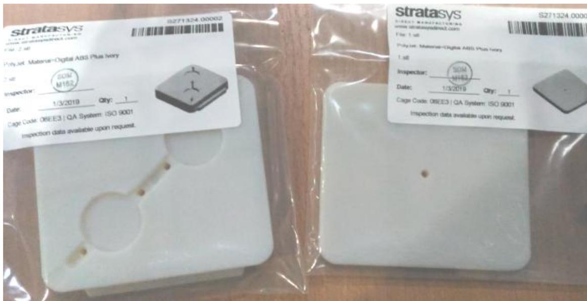
*Рисунок 13 – Комплект ФОД, изготовленный из материала Digital ABS Plus по технологии PolyJet (Stratasys)*
