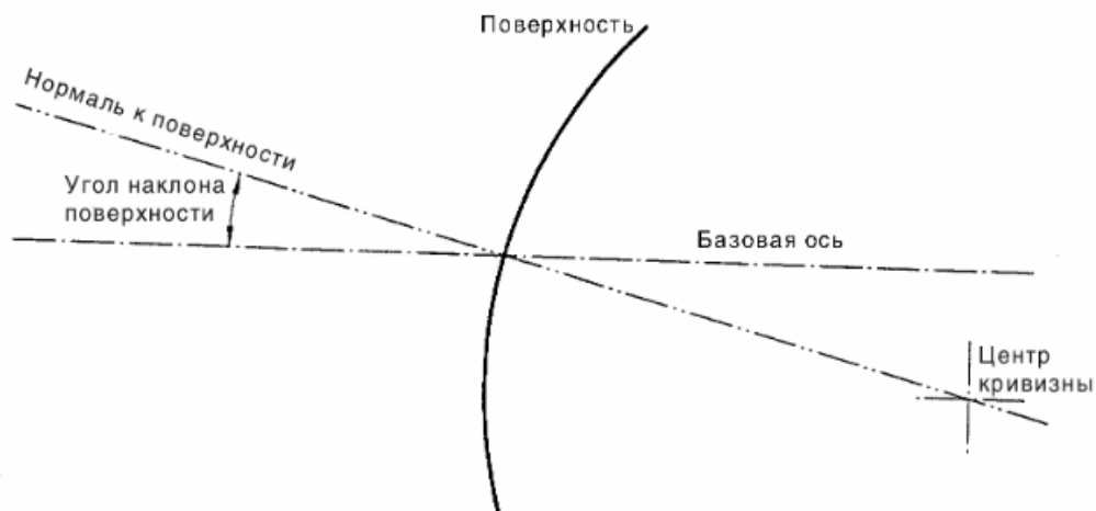
Рис.1.19 Угол наклона отдельной сферической поверхности
