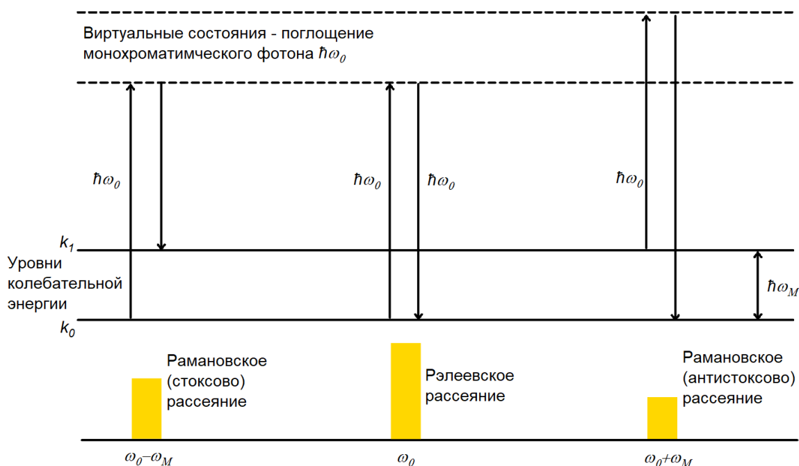
Рисунок 1.1 – Схема уровней энергии и переходов, отвечающих процессам неупругого (рамановского) и упругого (рэлеевского) рассеяния света, внизу - соответствующий им спектр
