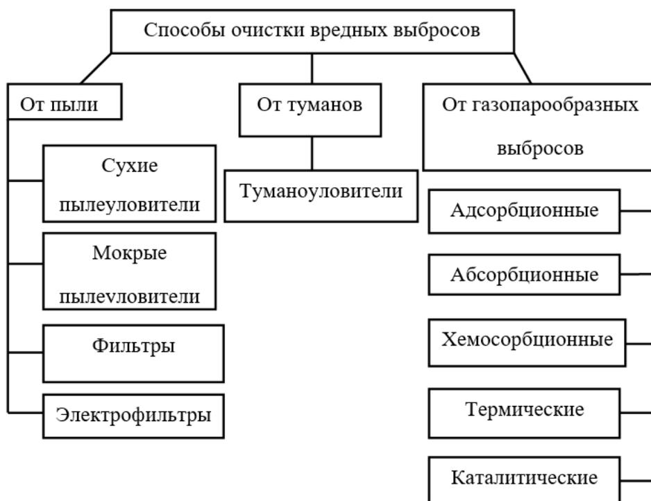
Рис. 1.2. Классификация способов очистки вредных выбросов
