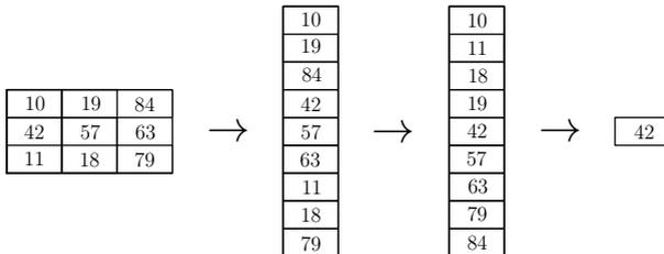
Рис. 4.5 — Иллюстрация работы медианной фильтрации в окне  $3 \times 3$ .
