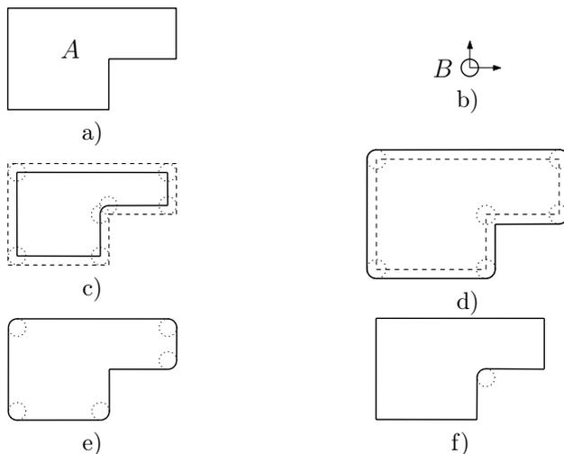
Рис. 5.1 — Результат выполнения операций бинарной морфологии: а) бинарный образ  $A$ , б) дисковый структурный элемент  $B$ , в) операция дилатации, г) операция эрозии, д) операция открытия, е) операция закрытия.
