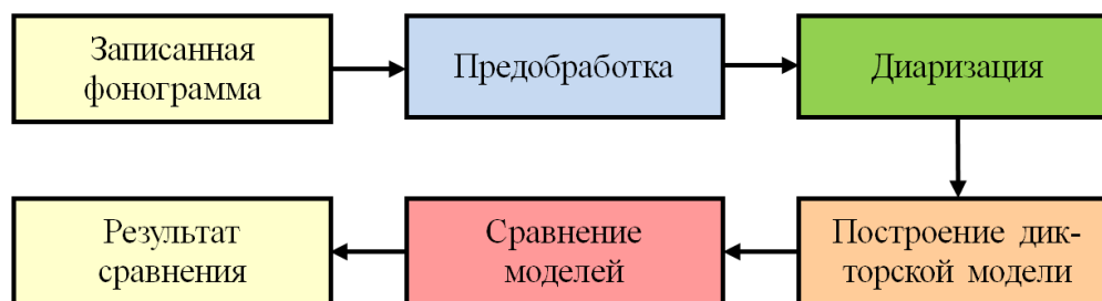
Рисунок 1 – Общая схема системы голосовой биометрии
