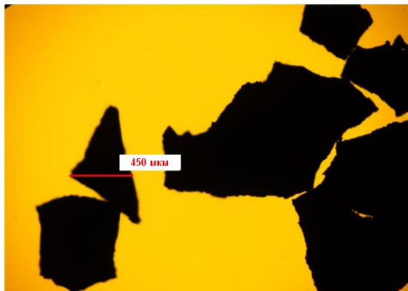
Рисунок 7 – Микрофотография частиц сульфида меди, сформированных осаждением из водного раствора
