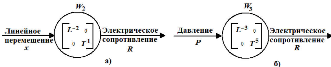
Рис. 5.2. Имитационные схемы размерностей тензорезисторов: а) линейных перемещений, б) давления
