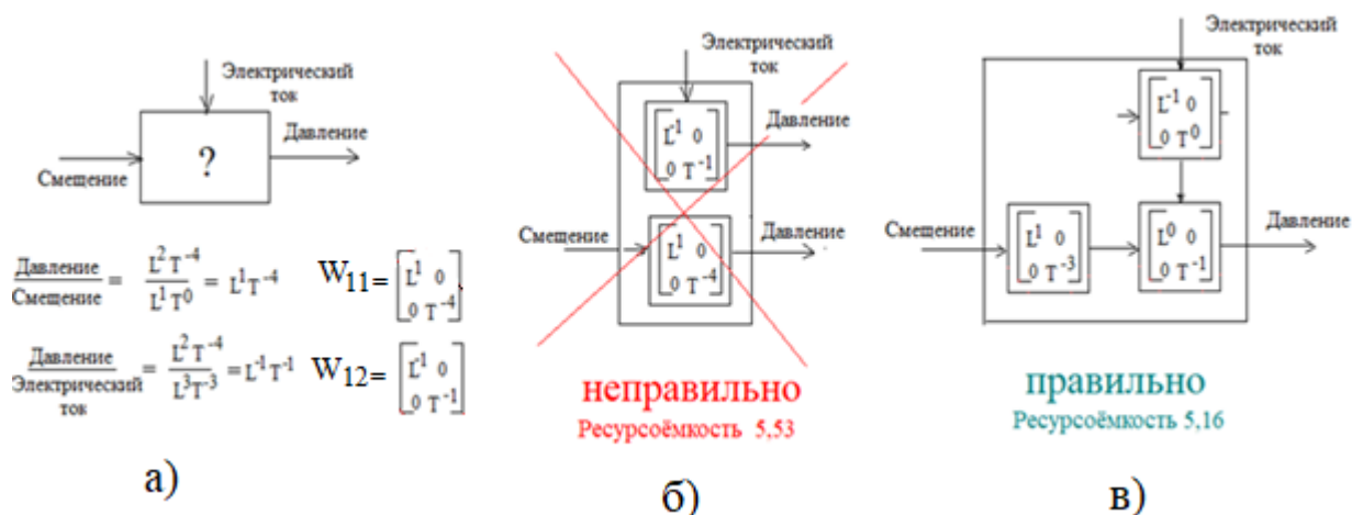
Рис. 5.5. Пример моделирования эффекта с двумя входами: а) передаточные матрицы, б) неправильная схема, в) правильная схема
