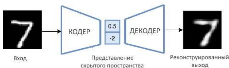
Рис. 4.33. Схема работы автоэнкодера
