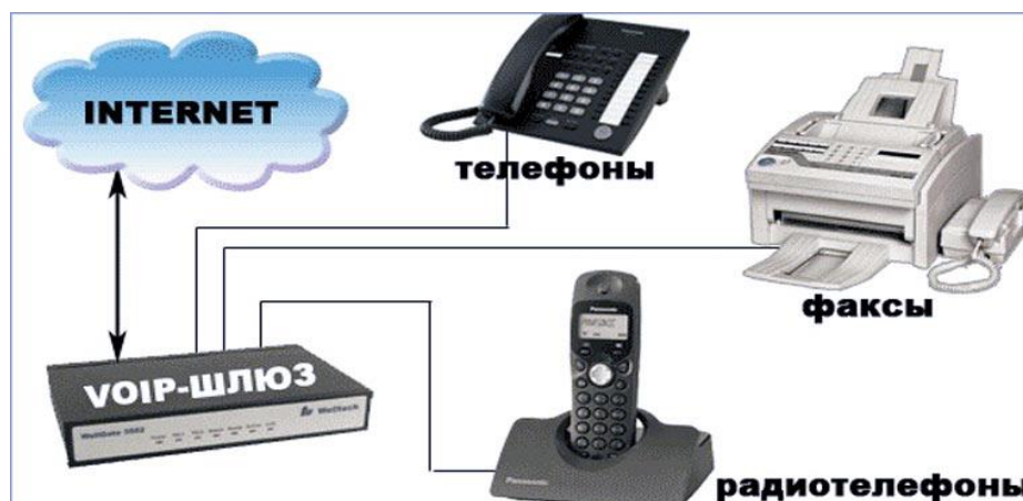
Рисунок 1.2. Пример подключения оборудования в IP-телефонии
