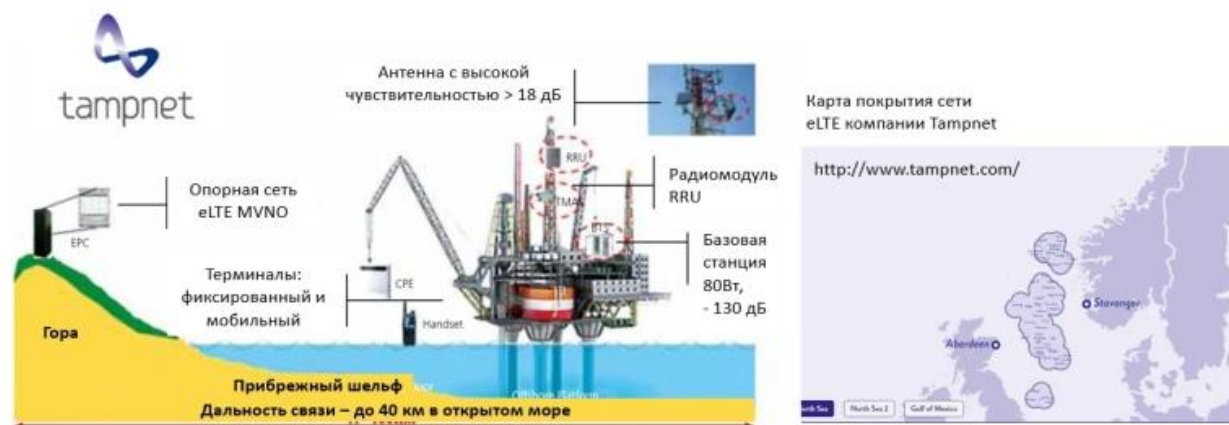
Рисунок 5.13. Применение ПМР eLTE в нефтедобывающей компании Tampnet
