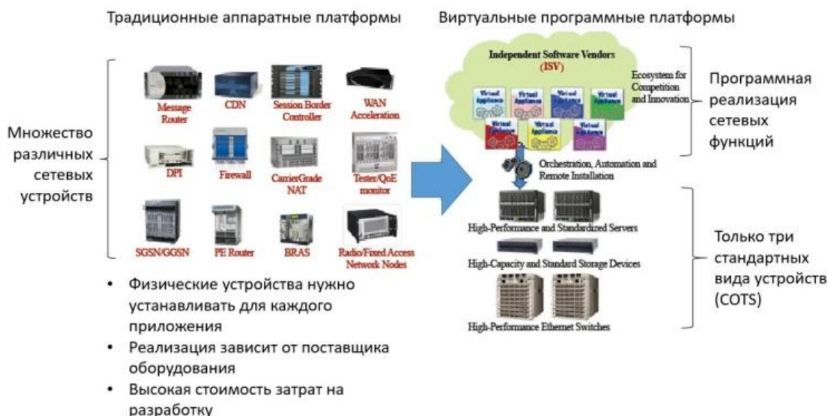
Рисунок 5.6. Цифровая трансформация операторских сетей на основе технологии виртуализации сетевых функций в стандартном ИТ-оборудовании
