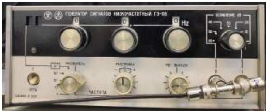
Рисунок 6.3 — Генератор сигналов ГЗ-118. *Сеть* – тумблер включения генератора сигналов низкочастотного ГЗ-118, *Множитель* – тумблер выбора коэффициента умножения, *Расстройка* – тумблер выбора величины расстройки, *Ослабление* – тумблер выбора величины ослабления
