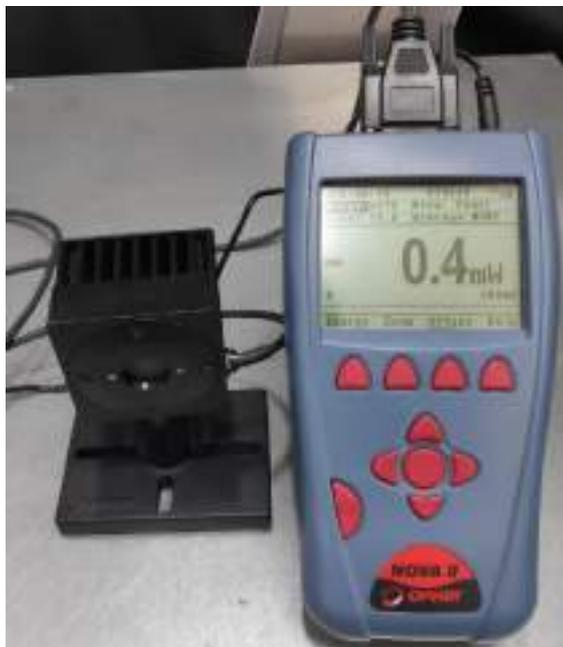
Рисунок 2.11 — Блок управления измерителя мощности NOVA II с измерительной головкой 30А-ВВ-18
