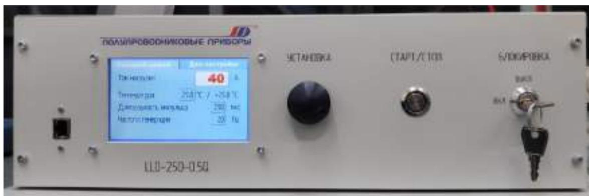
Рисунок 3.5 — Блок управления LLD-250-0,5Q. *БЛОКИРОВКА* – положения *ВКЛ/ВЫКЛ* ключа в замке блокировки, *СТАРТ/СТОП* – кнопка включения и выключения накачки линейки лазерных диодов, *УСТАНОВКА* – регулятор величины параметра
