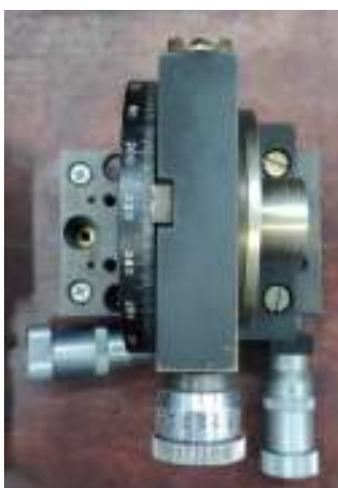
Рисунок 5.4 — Вращающиеся подвижки фазовых пластинок
