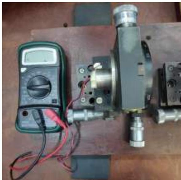
Рисунок 5.3 — Мультиметр М832, подключенный к фотоприемному элементу
