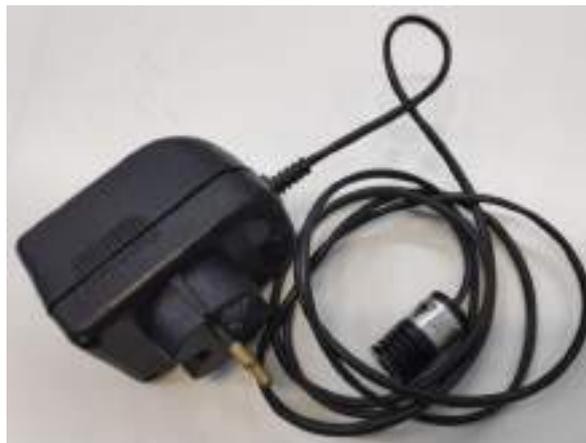
Рисунок 5.2 — Лазерный диод МЛ-02
