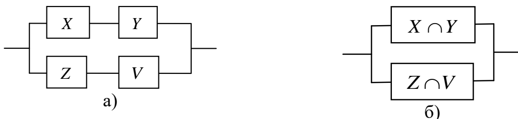
Рисунок 2.9 – Редуцированная структурная схема надежности сложной системы
