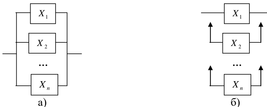
Рисунок 1.2 – Структурная схема постоянного резервирования (а) и динамического резервирования замещением (б)
