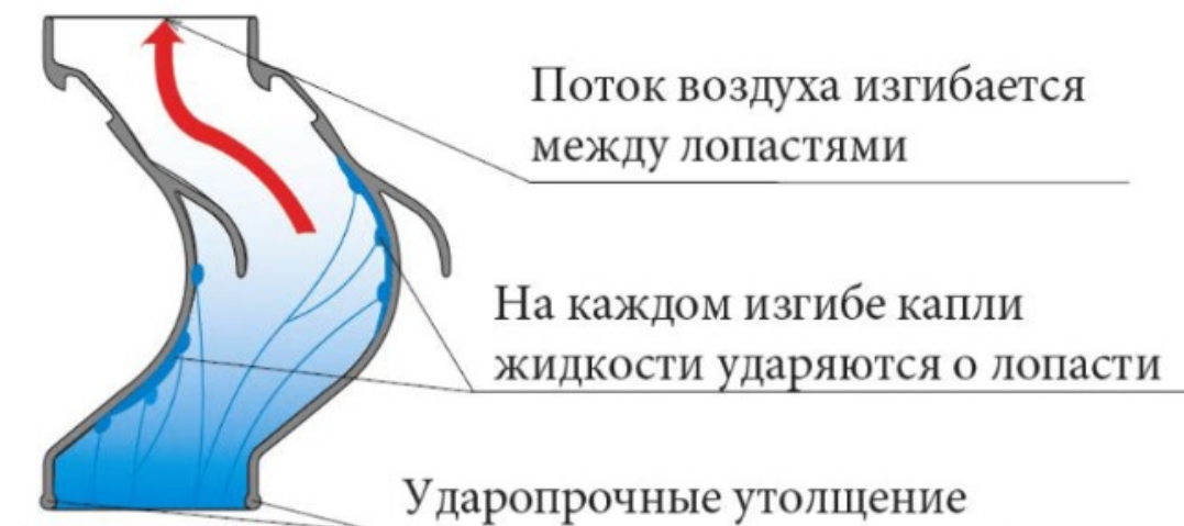
Рис. 38. Схема движения воздуха в каплеуловителе
