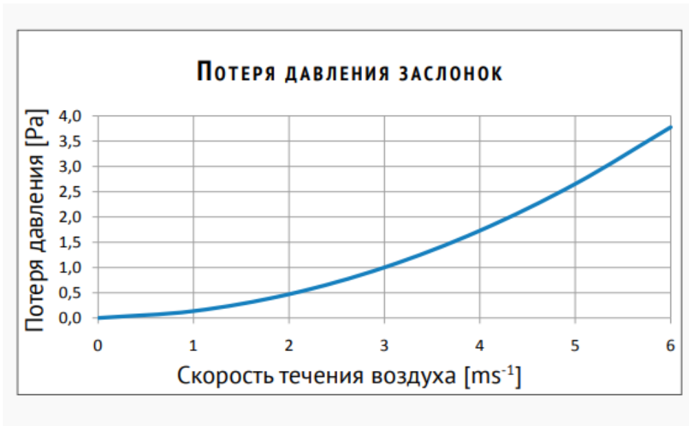
Рис. 27. Зависимость потери давления заслонки от скорости течения воздуха Re_{mak}
