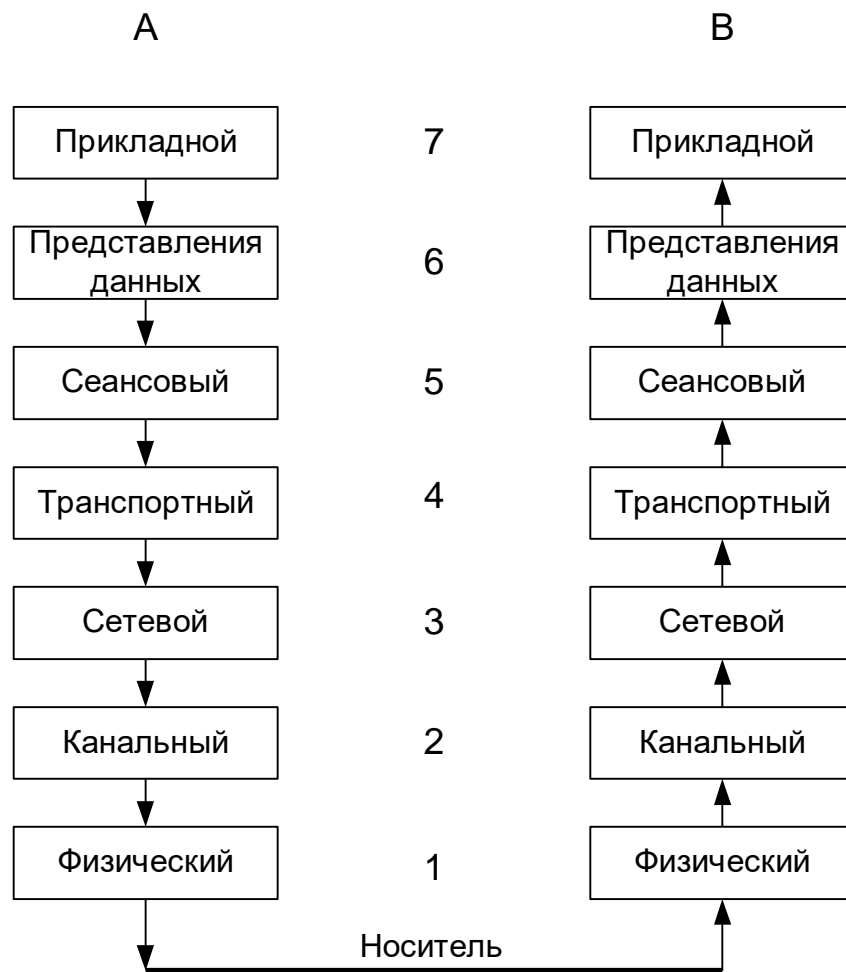
Рис. 1.7. Модель сетевого взаимодействия OSI
