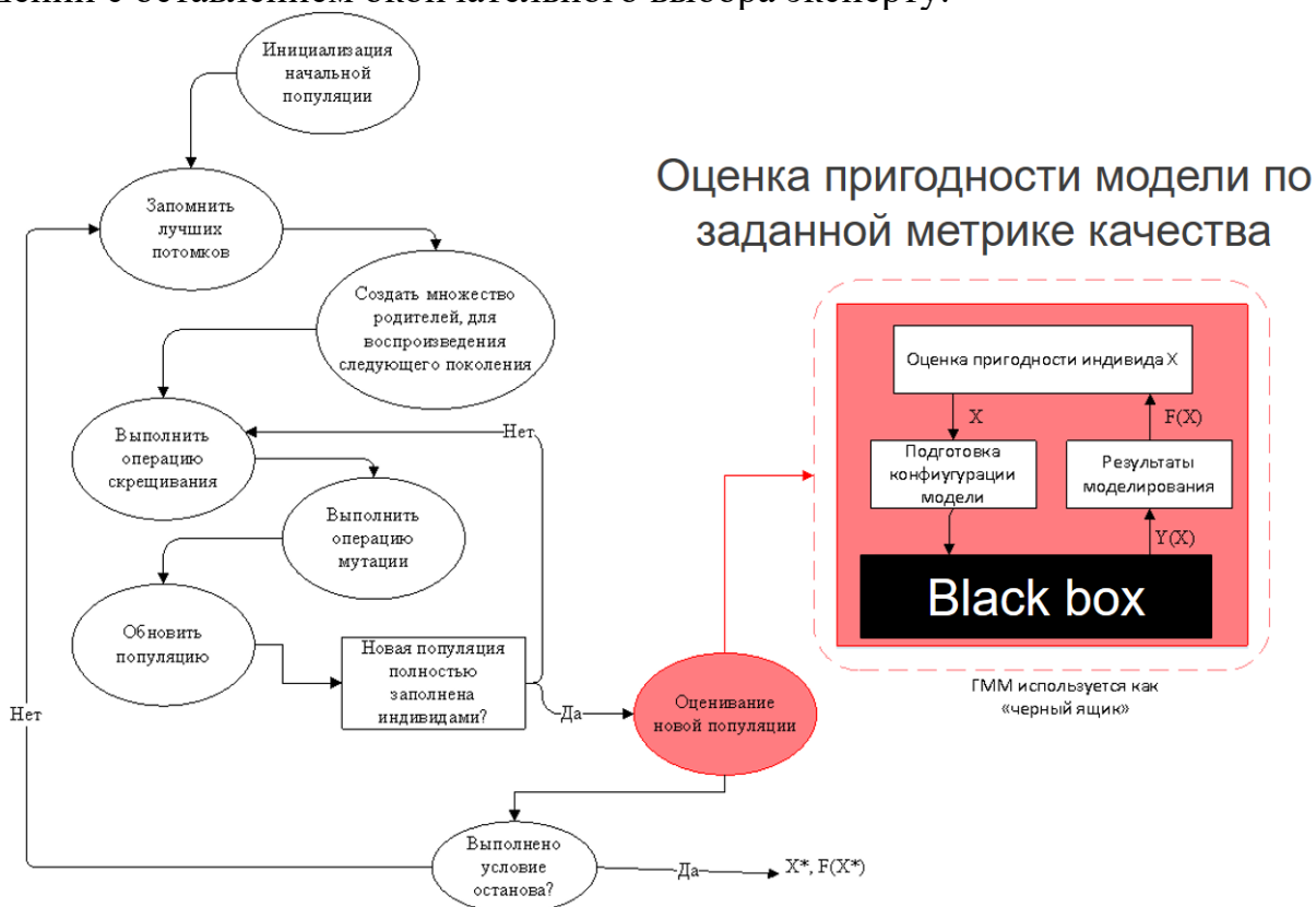
Рисунок 5.2.3 – Применение эволюционного алгоритма для решения задачи оптимизации «черного ящика»
