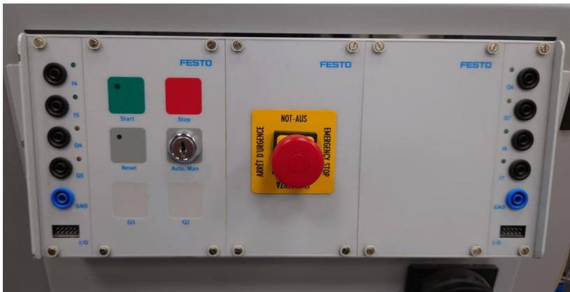
Рис. 2.2. Кнопка аварийной остановки на панели ячейки
