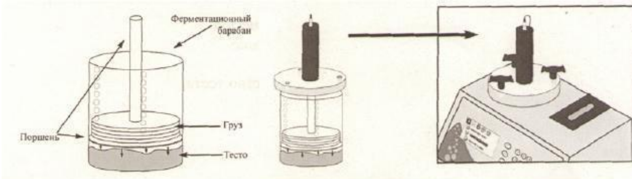
Рисунок 14 – схема сборки ферментационного барабана и его установки
