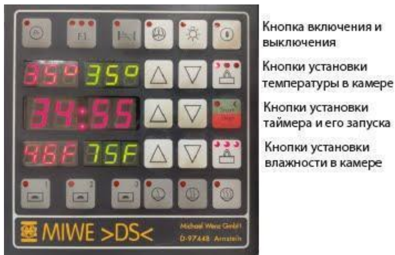
Рисунок 6 – Общий вид расстойной камеры и ее панели управления Miwe
