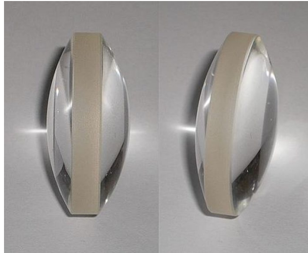
Рис. 6.14. Фотография настоящей линзы. Хорошо видно, что линза имеет 2 поверхности и ненулевую толщину.
