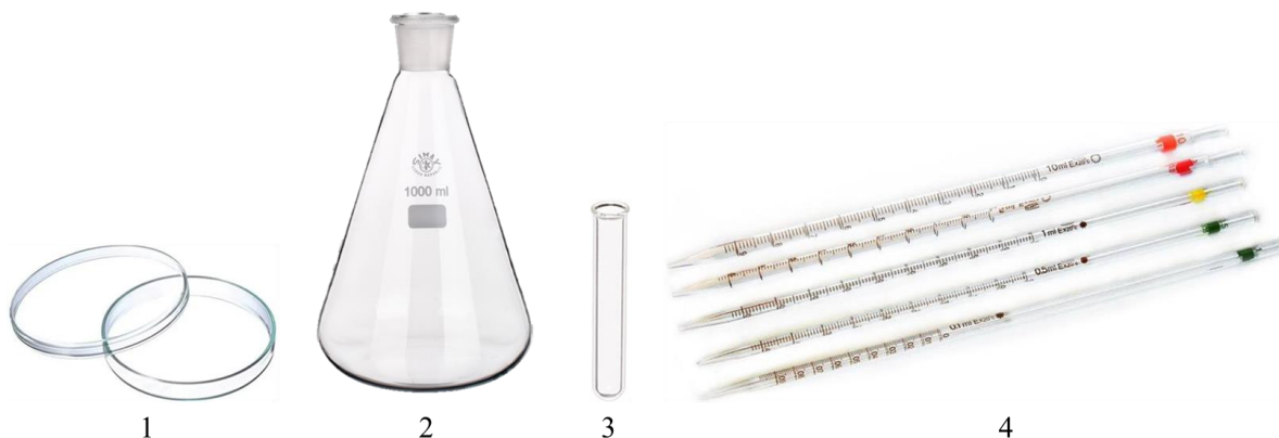
Рисунок 2.1 – Основные виды стеклянной посуды: 1 – чашки Петри; 2 – колба Эрленмейера; 3 – пробирки; 4 – пипетки
