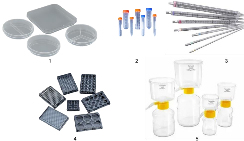
Рисунок 2.2 – Основные виды пластиковой посуды, используемой в микробиологических исследованиях: 1 – чашки Петри; 2 – пробирки; 3 – пипетки; 4 – культуральные планшеты; 5 – фильтрующая система с фильтром 0,22 мкм
