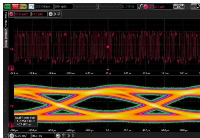
Рисунок 10 – Модулированный оптический сигнал и результирующая глазковая диаграмма
