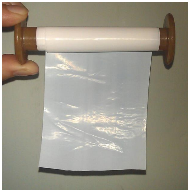
Рисунок 3 – Пористая пленка, полученная в непрерывном технологическом режиме
