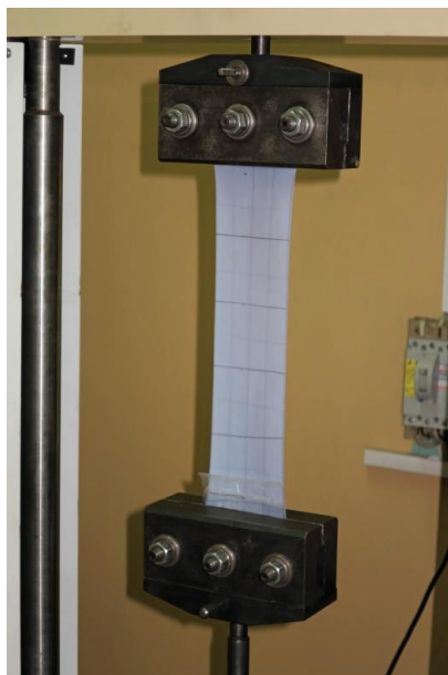
Рисунок 2 – Растяжение отрезка отоженной пленки на разрывной машине
