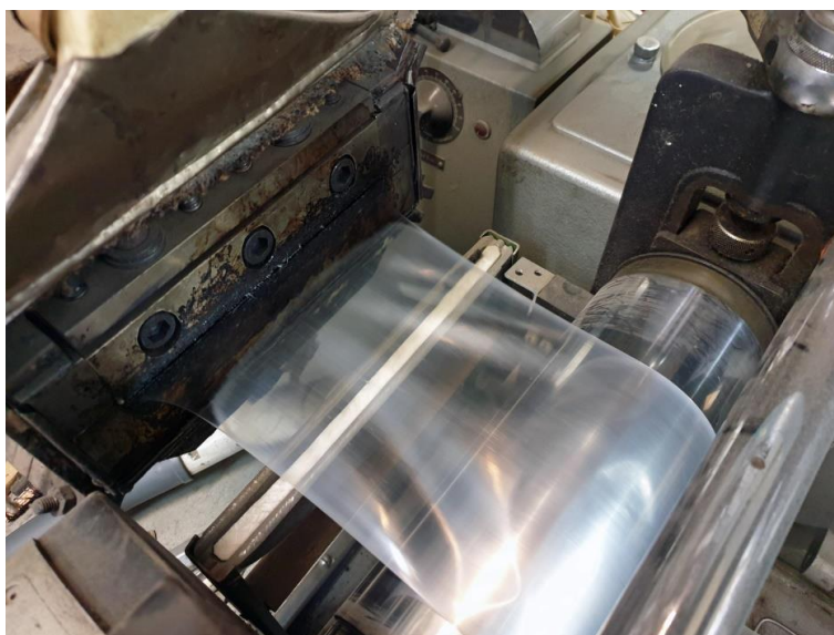
Рисунок 1 – Экструзия расплава полимера через плоскощелевую фильеру и прием пленки на валковое устройство
