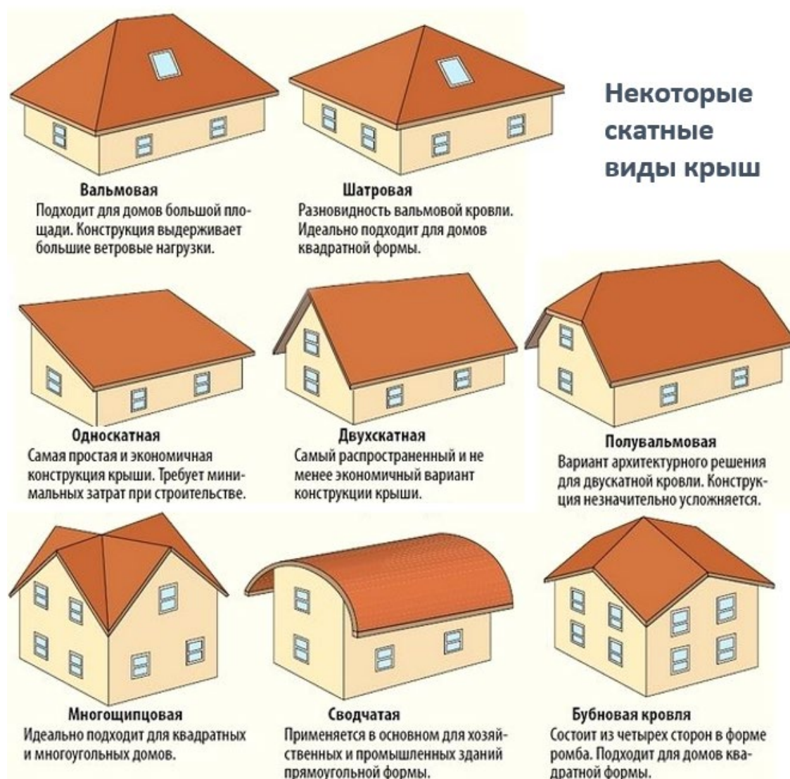
Рисунок 2.5 - Формы кровельного покрытия
