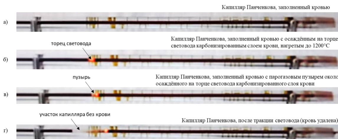
Рисунок 3.8. Модельные эксперименты поясняющие физические эффекты, происходящие в вене при лазерном воздействии [102].
