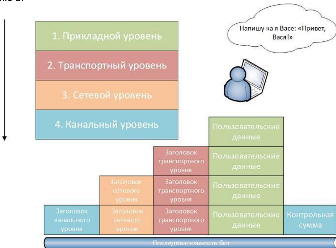
Рисунок 2 – Модель TCP/IP и распределение информации пакета по уровням
