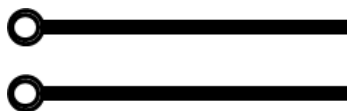
Рис. 47. Для снижения емкости между параллельными проводниками нужно размещать их по возможности дальше друг от друга
