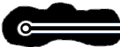
Рис. 50. Проводники со слабым сигналом нужно окружать «земляной» заливкой
