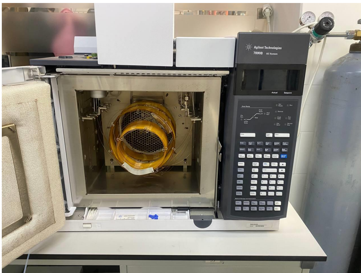
Рисунок 5 Термостатируемая камера газового хроматографа Agilent 7890b с двумя установленными капиллярными колонками
