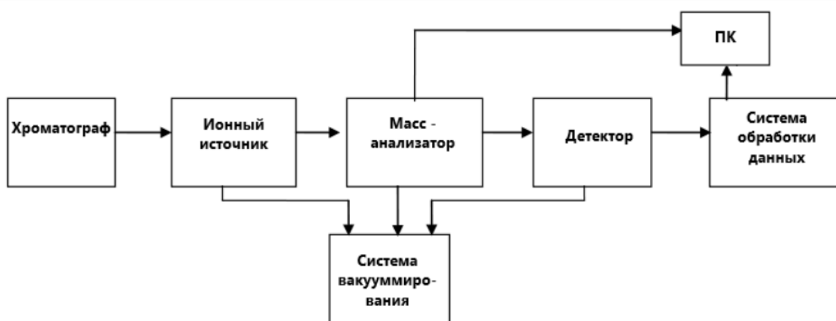
Рисунок 8 Схема основных узлов масс-селективного детектора
