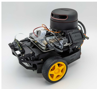
Рисунок 5.1. Мобильный робот с дифференциальным приводом
