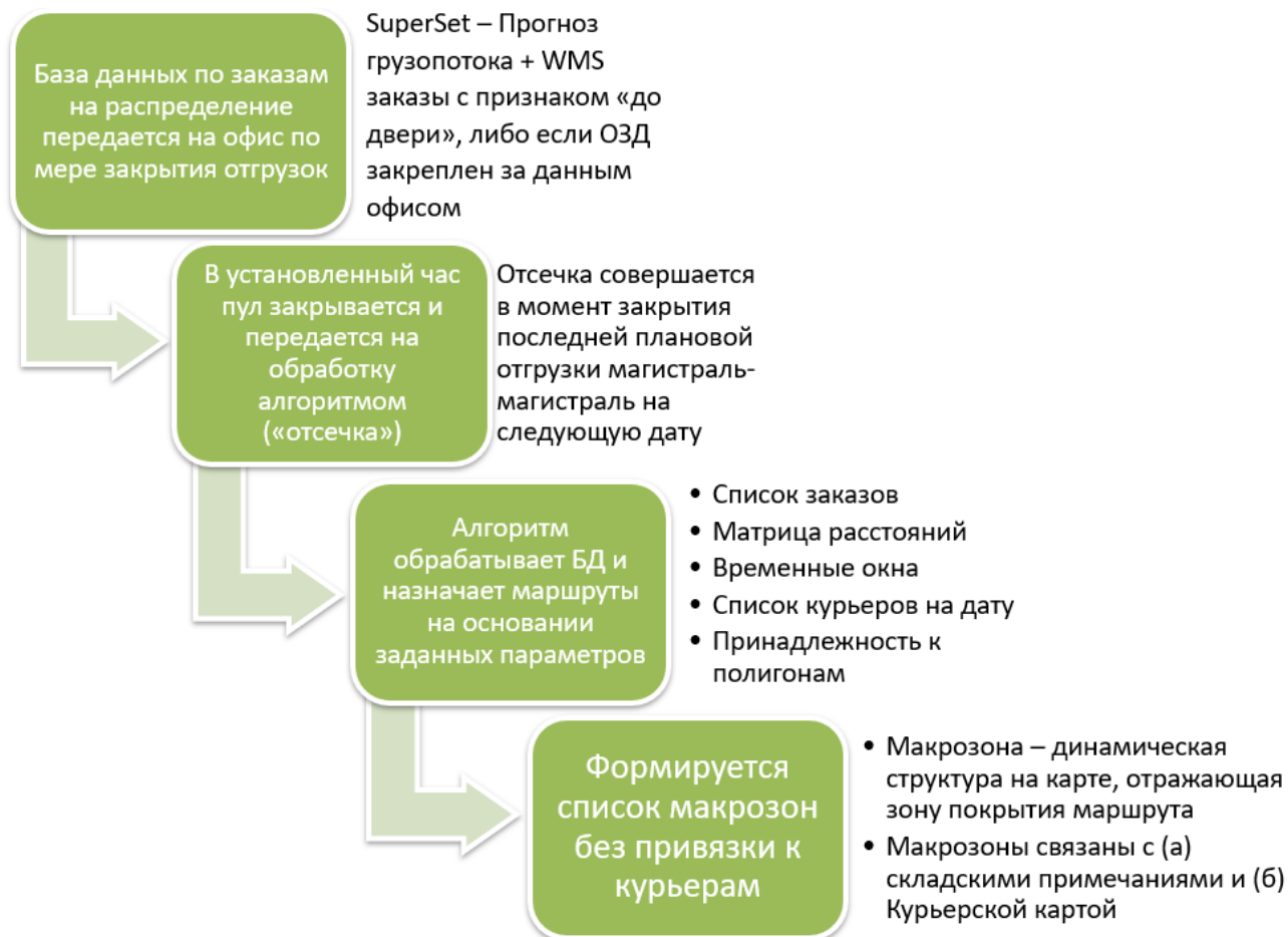
Рисунок 4 – Схема передачи и обработки данных на ОЗД от формирования списка заказов до назначения на конкретных курьеров
